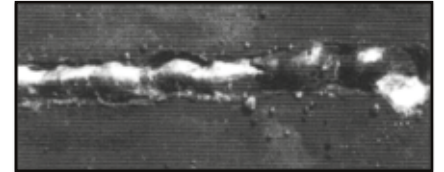
VIAJE MUY RÁPIDO, CORDÓN ESTRECHO, SOLDADURA POBRE EN EL PIE.
